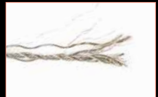
ROTURA POR UN BORDE AFILADO: Anticaídas de cable tradicional con absorbedor de energía
