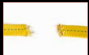
ROTURA POR UN BORDE AFILADO: Anticaídas de cincha tradicional
