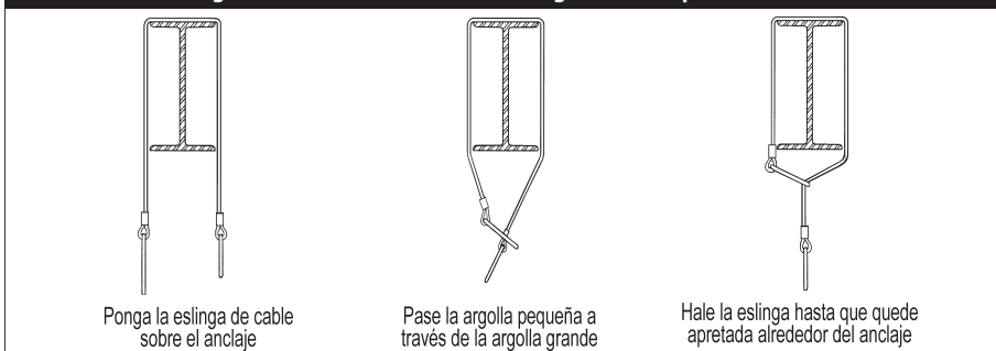
Figura 15 - Instalación de la eslinga de cable para ancla
