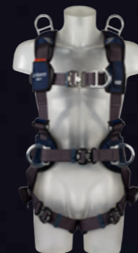
ExoFit NEX™ Imbracatura per edilizia/risalita Anelli a D sternale, dorsale e laterali Tech-Lite™, fibbie ad aggancio rapido Duo-Lok™, 2 anelli per il recupero verticale sulle spalle, imbottitura laterale e cintura di posizionamento integrate.
